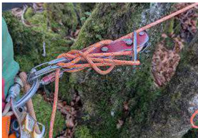
Freinage assuré avec 2 tours dans la poulie sup, renvoi vertaco, et mousqueton qui coiffe le tout
